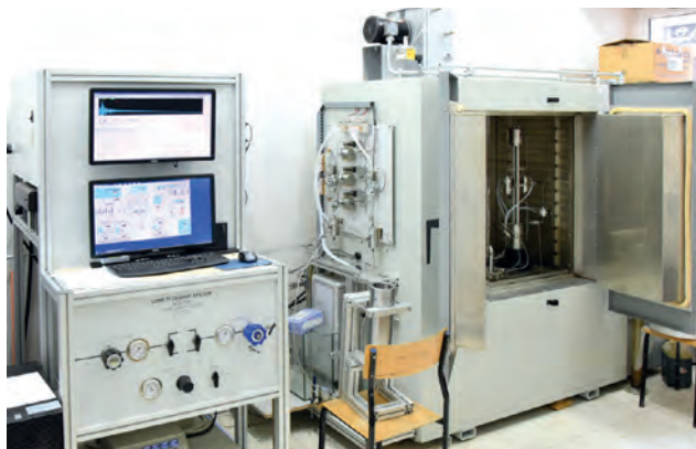
Laboratorium zaawansowanych metod wydobywania ropy naftowej. Zestaw do badania własności zbiornikowych skały i procesów wypierania węglowodorów w warunkach złożowych.
