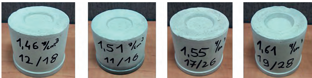
Zdjęcie 5. Próbkki kamieni cementowych po wyjęciu z analizatora Chandler SGSA
