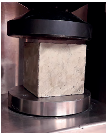
Zdj. 4. Badanie wytrzymałości (metoda niszcząca)
