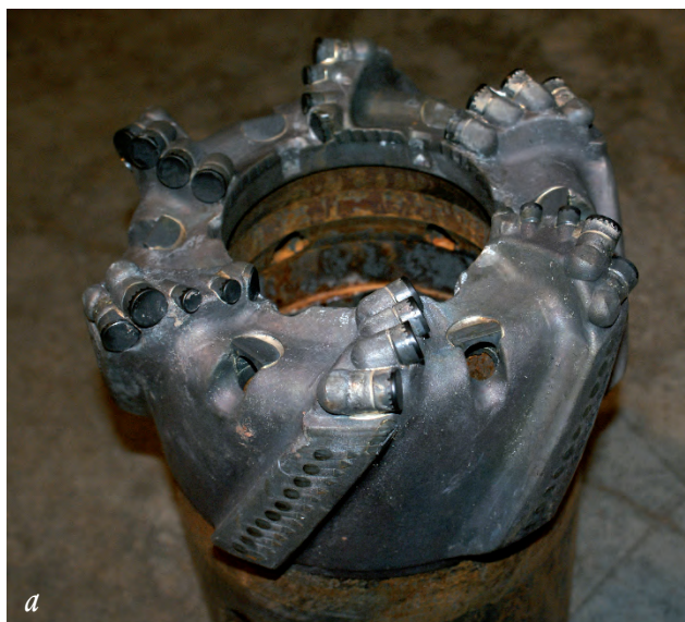
Rys. 5. Koronka rdzeniowa PDC 216mm matrycowa (a) i 149mm typu „Low Invasion” ze stalowym kadłubem (b). (fot. PN Diament)
