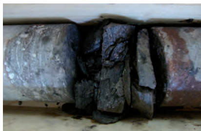
Rys. 1. Wykształcenie litologiczne serii złożowej rudy miedzi w otworze G-12: dolomit (a), łupek (b), piaskowiec (c). (fot. D. Janc)
