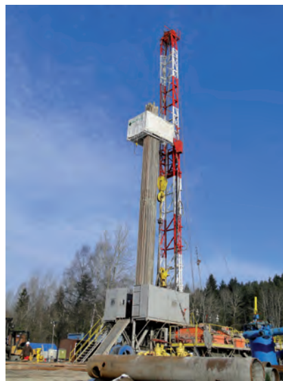
Urządzenie wiertnicze typu IDECO DIR 700 PNiG Jasko – Oddział Naftgaz w Wołominie Fot. S. Sieradzki
