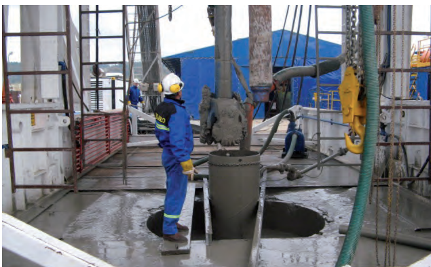
Na wiertni; oblepiony płuczką wiertniczą świder, wyciągnięty z odwiertu. Fot. S. Sieradzki
