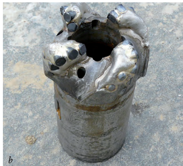
Rys. 5. Koronka rdzeniowa PDC 216mm matrycowa (a) i 149mm typu „Low Invasion” ze stalowym kadłubem (b). (fot. PN Diament)
