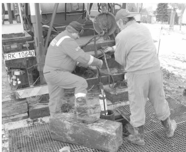
Zapuszczanie torpedy do otworu. (fot. ze zbiorów autora).
