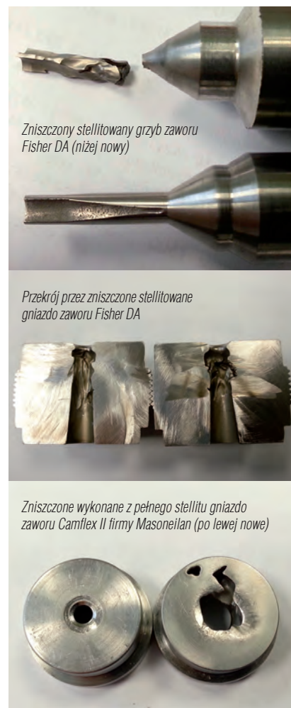
Fig. 5. Uszkodzenia elementów wewnętrznych zaworów
