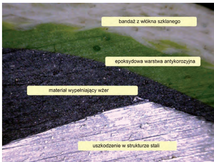
Fot. 1. Przekrój przez warstwy systemu Syntho-GlassXT
