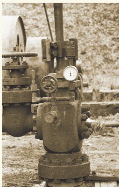
Głowica otworu gazowego kopalni Strachocina. Na manometrze widnieje wskazane ciśnienie 70 atm. (fot. archiwum Fundacji Bóbrka)
