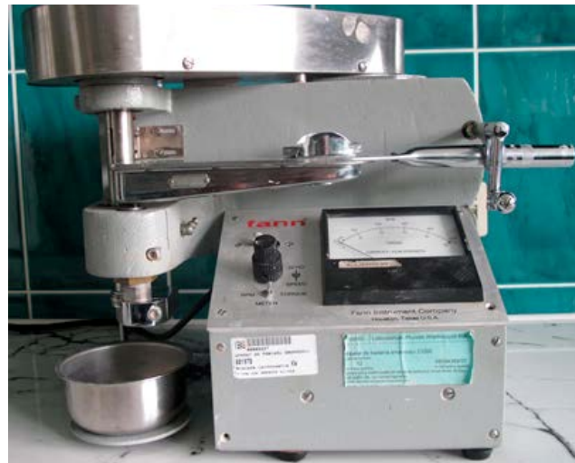
Fot. 6. Aparat do badania właściwości smarnych cieczy wiertniczych – EP Lubricity Tester Model 212 EP
