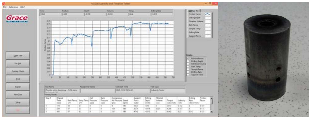
Fot. 9. Przykładowe wyniki pomiaru współczynnika tarcia przy różnych wartościach nacisku oraz rotor
