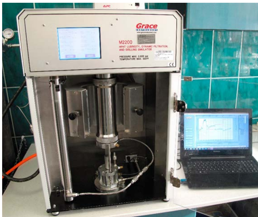
Fot. 1. Wielofunkcyjny symulator procesu wiercenia w warunkach HPHT Grace model M2200
