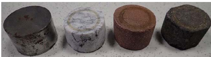
Fot. 7. Próbkę wykorzystywane podczas badań smerności; od lewej: stal, anhydryt, piaskowiec, dolomit
