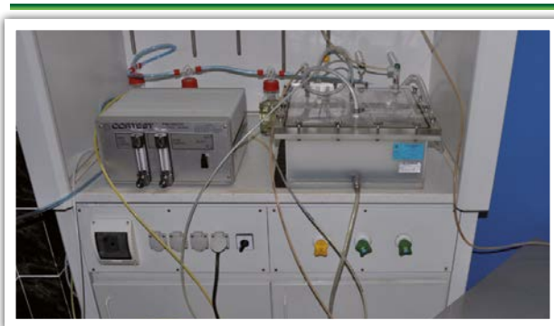
Stanowisko do badań właściwości mechanicznych skał metodą akustyczną
