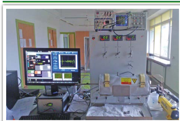
Stanowisko do badań właściwości mechanicznych skał metodą akustyczną
