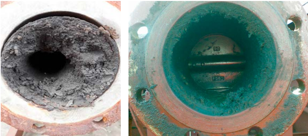
Rys. 1. Intensywna redukcja średnicy wewnętrznej (z 6" do 2") rurociągu przesyłowego ropy naftowej oraz okolic zaworu odcinającego
