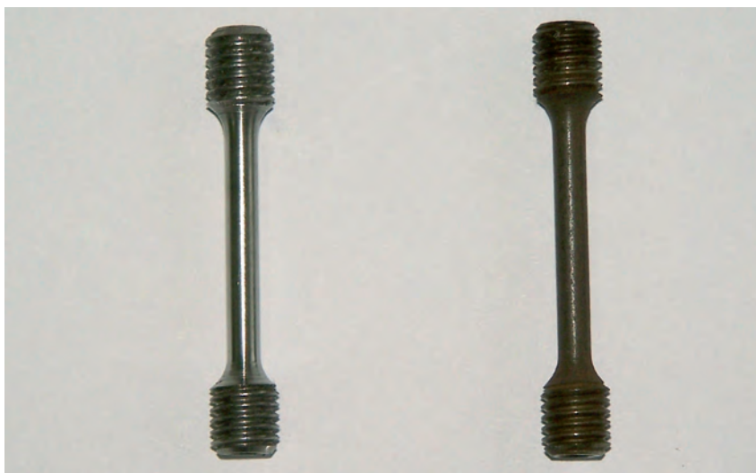
Rys. 2. Próbkę wykonaną ze stali gatunku P 355 NL 1 (blachy), z lewej próbka przed testem, z prawej próbka spełniająca wymogi testu
